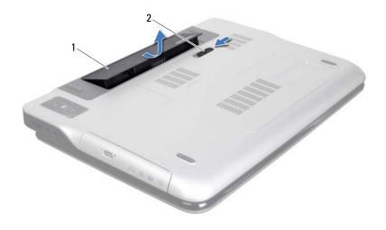
1 Batterie 2 Riegel der Akkufach-Freigabevorrichtung
