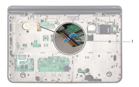
1 Anschluss des USB-Platinenkabels
